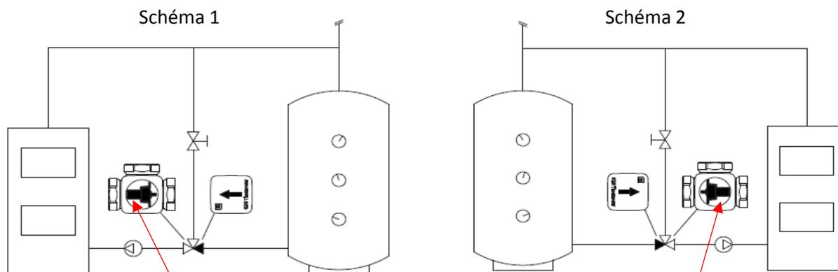
**Le bulbe de la cartouche thermostatique doit toujours être du côté de la chaudière**
