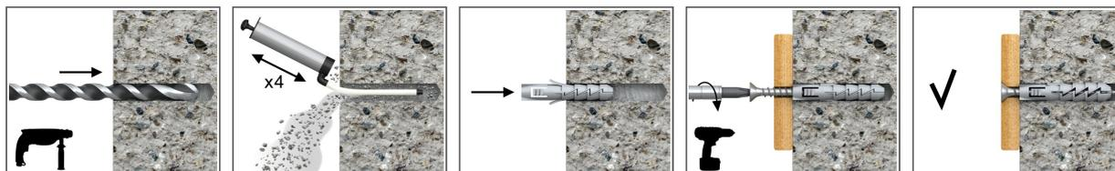
1. Percer un trou au diamètre recommandé.
