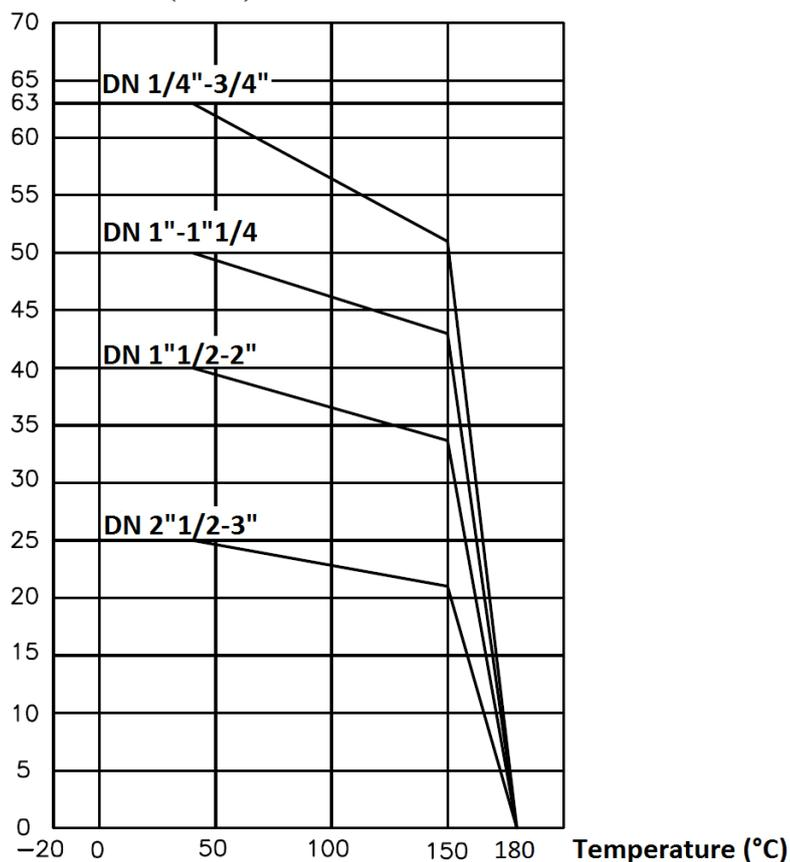
**COUPLES DE MANŒUVRE ( en Nm sans coefficient de sécurité ) :**
